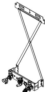
Допоміжний монтажний пристрій для відкритого монтажу
