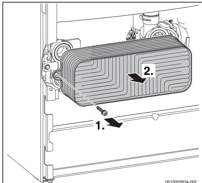
Мал. 57 Демонтаж пластинчастого теплообмінника
