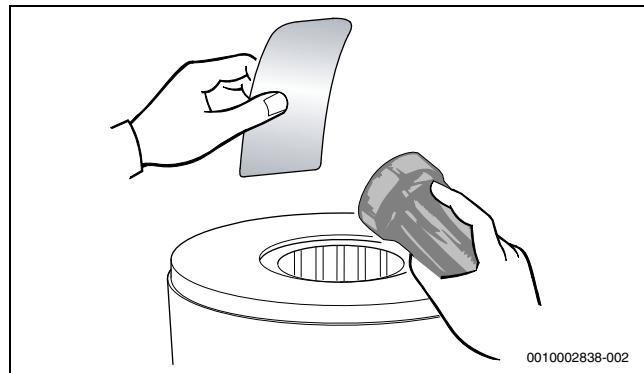
Мал. 47 Перевірка котлового блока, який включає камеру згоряння і теплообмінник, на наявність відкладень
