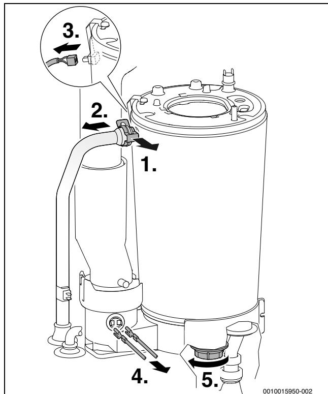
Мал. 63 Від'єднання труби лінії подачі та зняття кабелю
