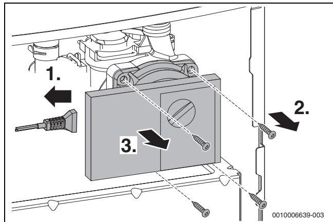
Мал. 60 Демонтаж насоса опалювального контуру
