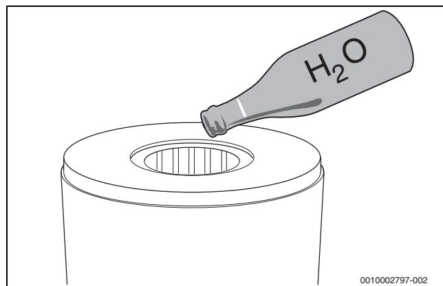
Мал. 48 Промивання водою котлового блока, який включає камеру згоряння і теплообмінник
