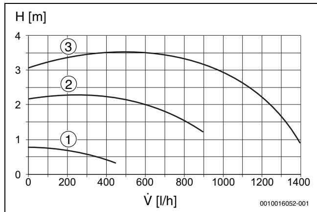
Мал. 34 Характеристична крива насоса опалювального контуру (пропорційний тиск)
