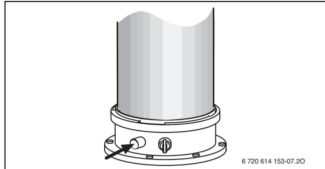
Мал. 35 Вимірювальний штуцер димових газів
