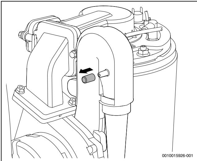
Мал. 39 Штуцер для вимірювання на змішувальній камері
