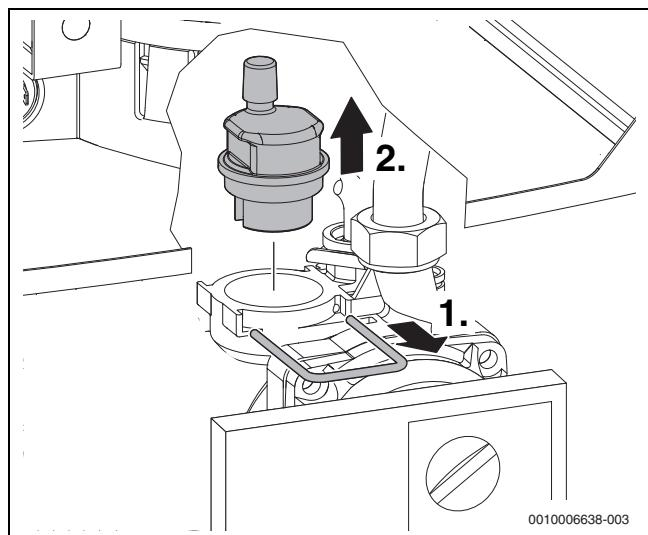
Мал. 61 Демонтаж автоматичного повітровідокремлювача
