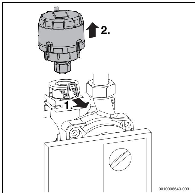
Мал. 62 Демонтаж двигуна 3-ходового клапана
