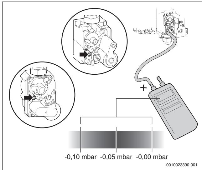
**Налаштування різниці тиску газового клапана**
