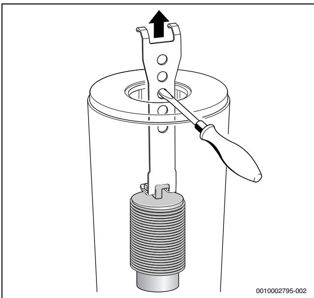
Мал. 45 Виймання нижнього елемента теплообмінника, що служить для оптимізації розподілювання тепла
