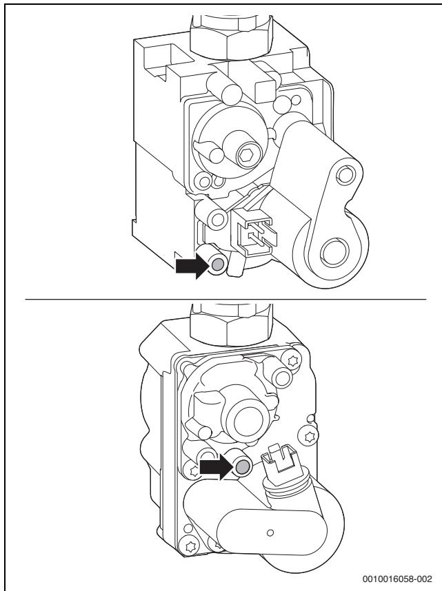
Мал. 37 Штуцер для вимірювання тиску підключення газу
