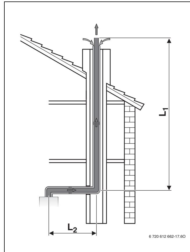
Мал. 9 Відведення димових газів з концентричною трубою в шахті згідно з С<sub>33</sub>
