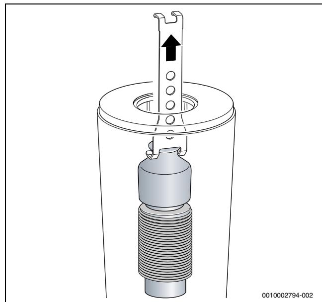
Мал. 44 Виймання верхнього елемента теплообмінника, що служить для оптимізації розподілювання тепла
