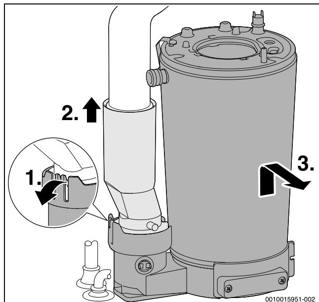
Мал. 64 Демонтаж котлового блока, який включає камеру згоряння і теплообмінник
