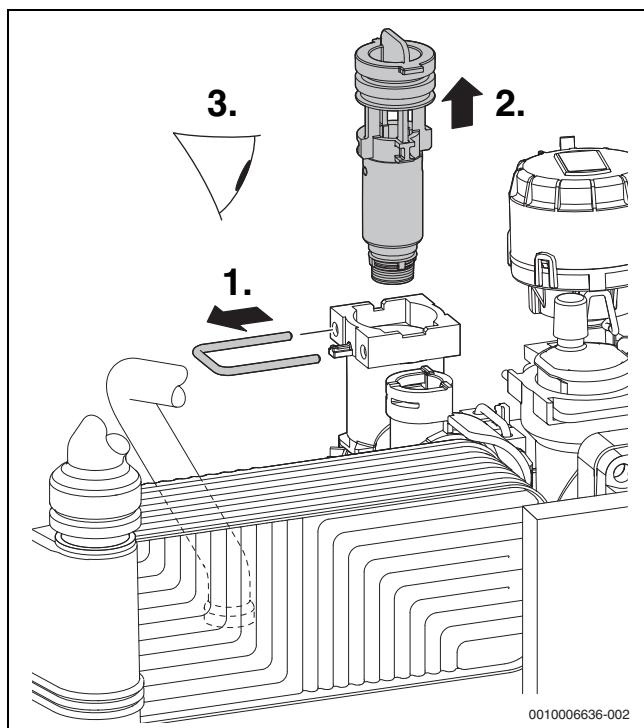
Мал. 56 Перевірка фільтра в трубі холодної води
