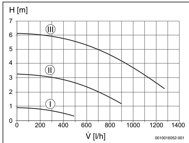
Мал. 33 Характеристична крива насоса опалювального контуру (постійна частота обертання)
