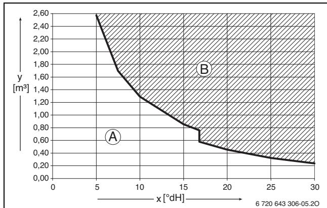
Мал. 20 Вимоги до води для заповнення та підживлення в  $^{\circ}\text{dH}$  для приладів потужністю < 50 кВт
